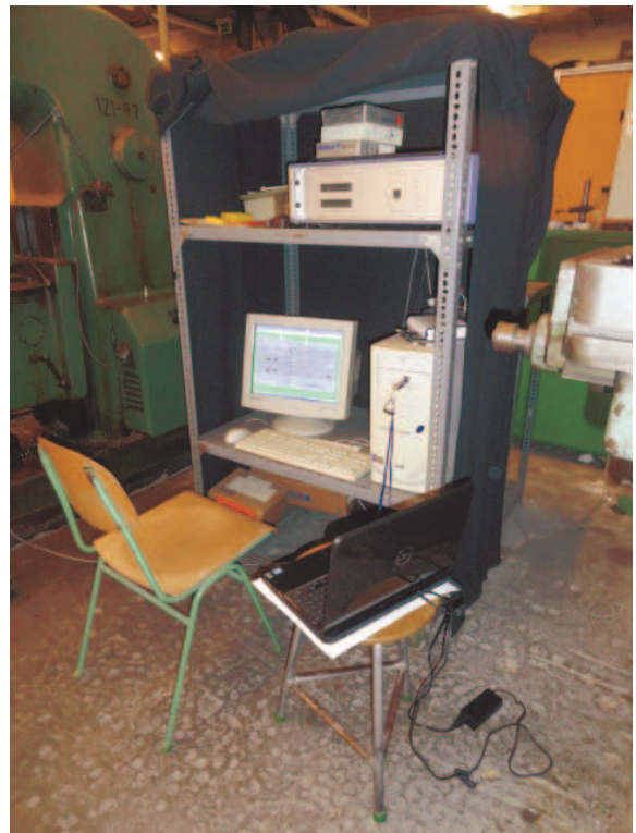
34. ábra: VF-22 marógéphez rendelt mérőhely KISTLER 9863A feszültségjel erősítővel
