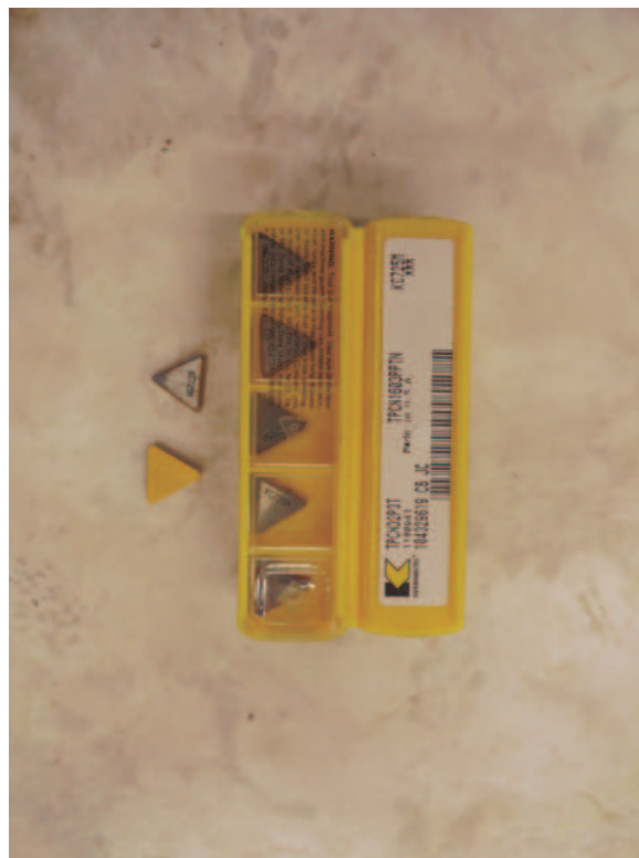
36. ábra: Kennametal TPCN1603PPTN KC725M keményfém lapkák
