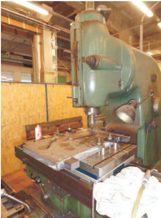
33. ábra: VF-22 függőleges marógép és KISTLER 9281B piezoelektromos erőmérő
