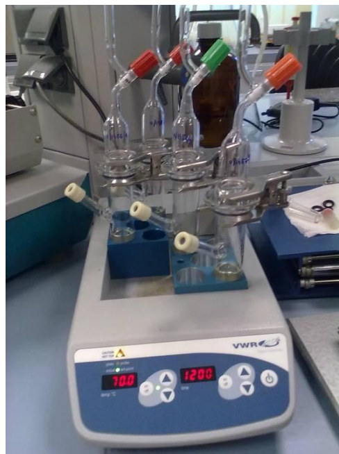
6. kép 70-75 °C-on történő melegítés a minta és a foszforsav adagolása után (forrás: Molnár Anita)
