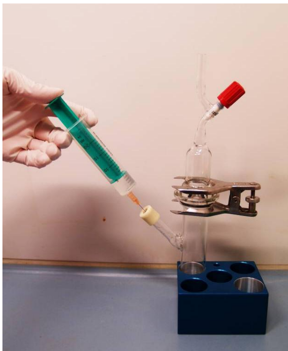
8. kép Foszforsavdagolás a minta szerves széntartalmának feltárásának céljából (forrás: ATOMKI)
