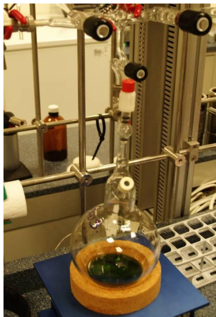
3-4. kép A TC (krómkénsavas) és DIC (foszforsavas) feltáráshoz alkalmazott szeptumos ampulla és az NPOC feltárásban használt szeptumos gömblombik (forrás: Molnár Anita)
