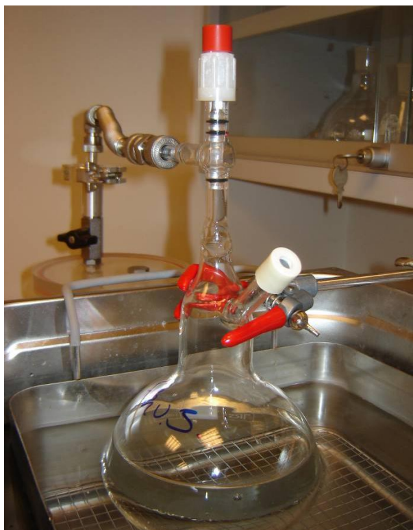
17. kép A módszerhez használt leghatékonyabb lombik szeptummal és üvegcsappal ellátva (forrás: Molnár Anita)
