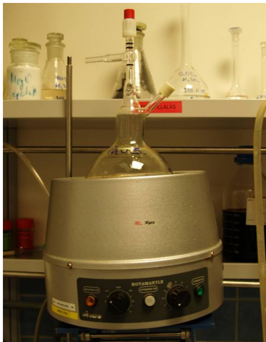
14. kép Krómkénsavval történő melegítés fűtőkosárban min. 100 °C-on
