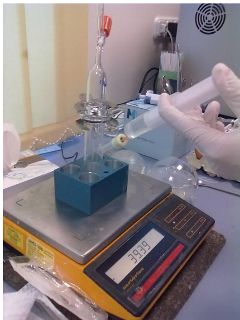
5. kép Mintaadagolás a szeptumon keresztül (forrás: Molnár Anita)
