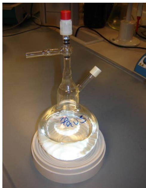
11. kép A foszforsavat és a mintát tartalmazó szeptumos üvegcsapos lombik
