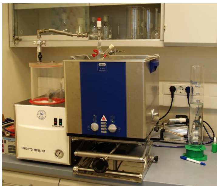
9. kép NPOC C-14 tartalmának feltárásához szükséges előkészítési technika (forrás: Molnár Anita)
