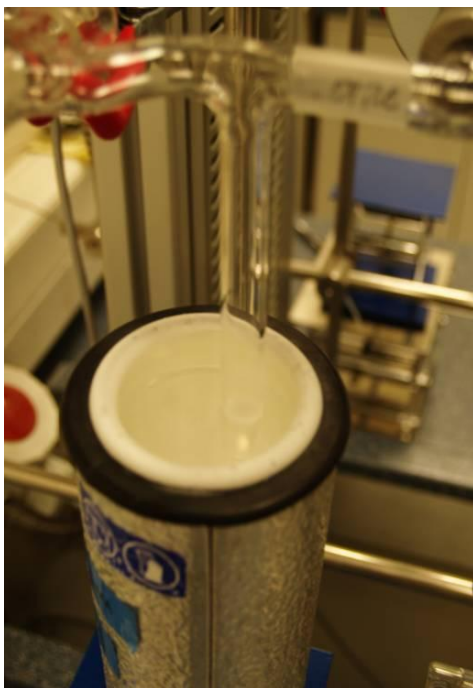
21. kép A minta \text{CO}_2 tartalmának kifagyasztása folyékony nitrogénnel az ismert térfogatban (forrás: Molnár Anita)
