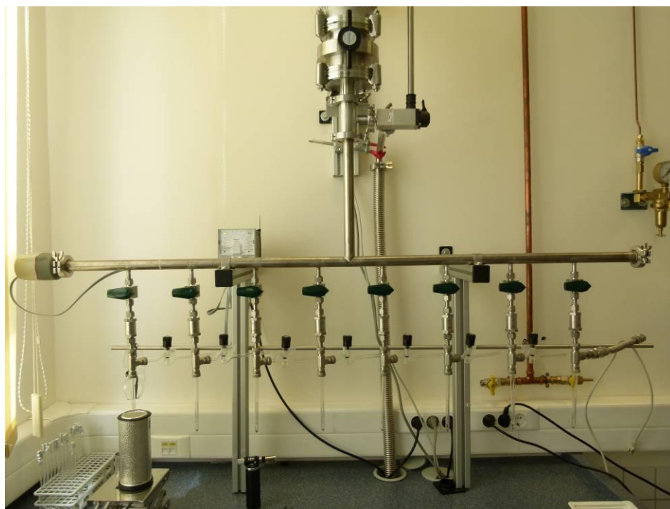
25. kép Zártcsöves grafitizáló rendszer (forrás: Molnár Anita)
