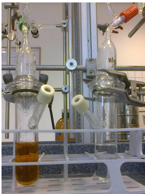
3-4. kép A TC (krómkénsavas) és DIC (foszforsavas) feltáráshoz alkalmazott szeptumos ampulla és az NPOC feltárásban használt szeptumos gömblombik (forrás: Molnár Anita)
