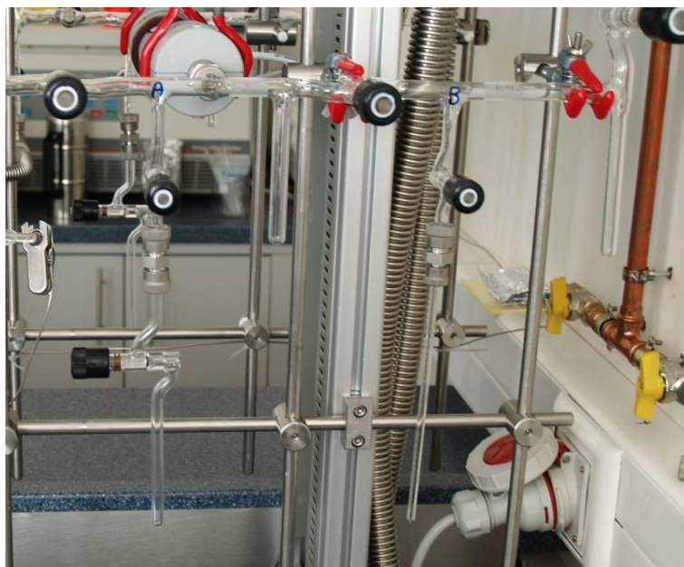
7. kép Ismert térfogat az AMS feltáró rendszeren (forrás: Molnár Anita)
