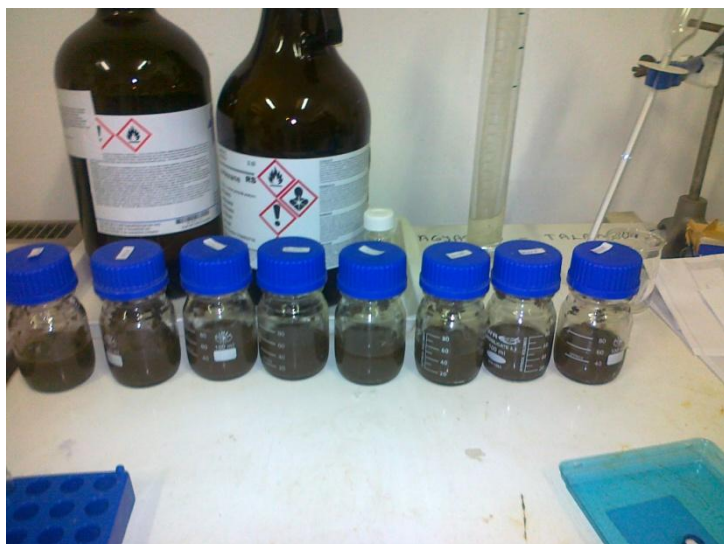
8. ábra Debreceni Repülőtér I. számú üzemanyagtároló területéről származó talajminták extrahálás után, Forrás: Saját készítés
