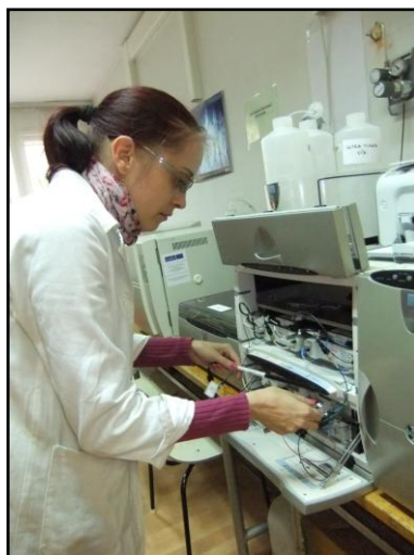
12. kép: Kolonna beszerelése
