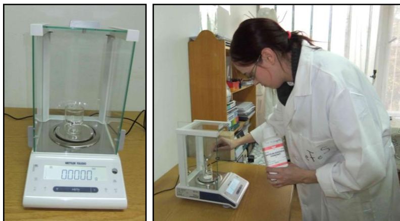
9. kép: \text{Na}_2\text{CO}_3 és \text{NaHCO}_3 bemérése analitikai mérlegen
