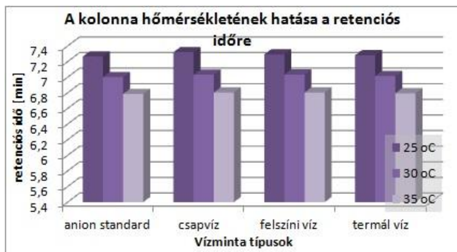
13. ábra: A kolonna hőmérsékletének hatása a bromid-ion retenció idejére (körülmények: kolonna: ASI4A; eluens: 8 mmol/l \text{Na}_2\text{CO}_3 és 1 mmol/l \text{NaHCO}_3 ; áramlási sebesség: 1 ml/min; detektor hőmérséklete: 25 °C, kolonna hőmérséklete 25 °C, 30 °C és 35 °C; ASRS szupresszor; injektált minta: 25 \mu\text{l} )
