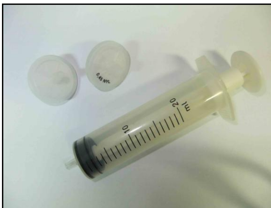
6. kép: Fecskendő és 0,45\mu\text{m} -es membránszűrő
