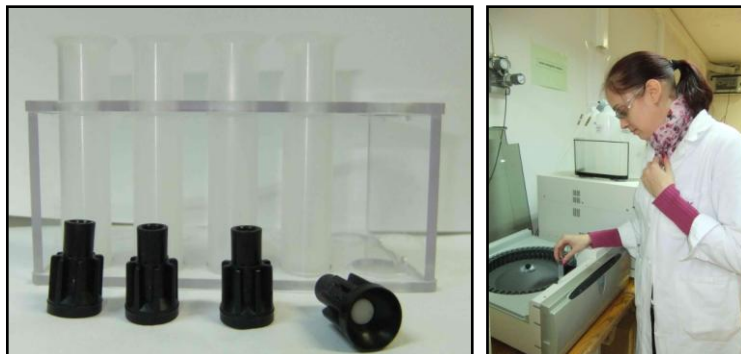
7. kép: Mintatartó fiola és a szűrővel ellátott kupak
