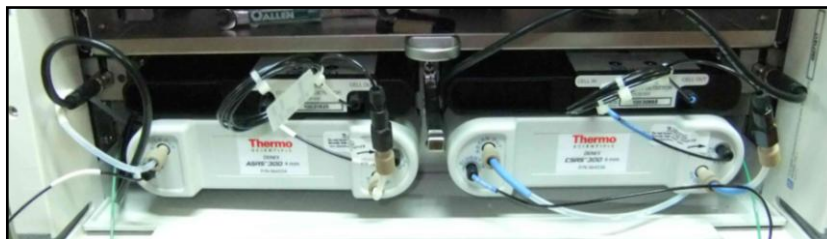
5. kép: Szuppresszor (fehér színű egység) és a vezetőképesség detektor (fekete színű egység)
