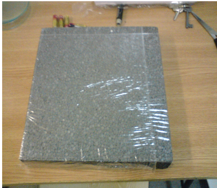
13. Ábra A kiszárított (szürke) mintadarab klímakamrába való behelyezés előtt
