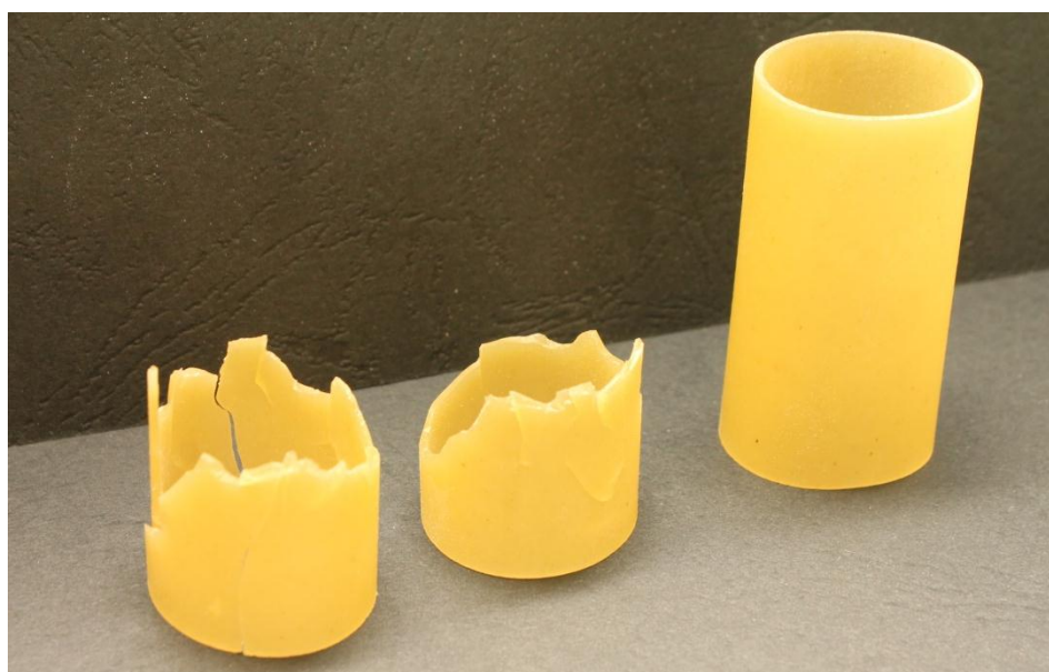
10. ábra Cannelloni próbatest a roncsolás után (saját kép)
