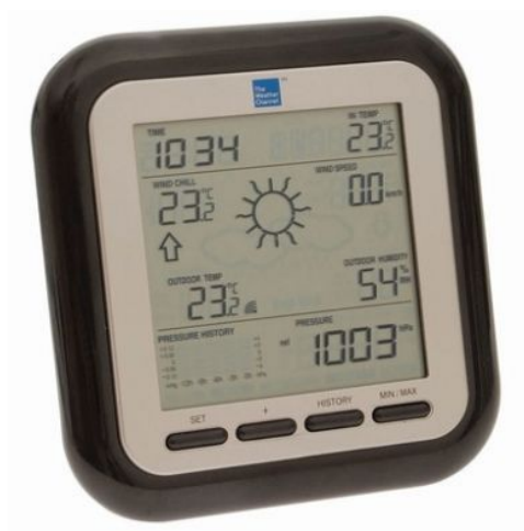
14. kép: Millennium MN9311 típusú mini időjárás állomás
