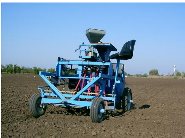
2. ábra. Wintersteiger Oyjord típusú, programozható parcellavetőgép
