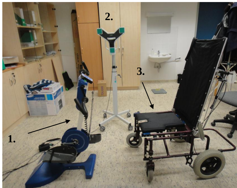
1. kép: Mérési berendezés: 1. Kar ergométer 2. Ultrahang alapú vevőfej 3. Rögzített szék
