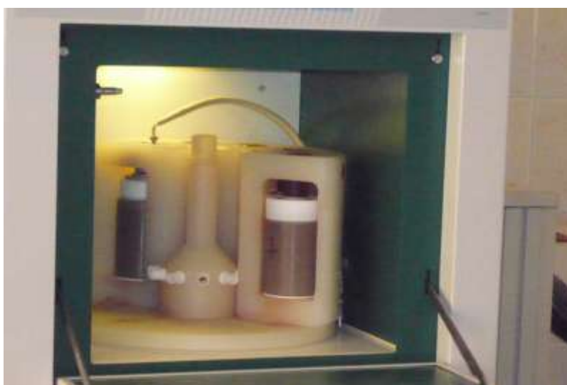
16. ábra. A roncsolóba helyezett bombák
