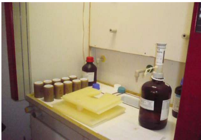
13. ábra. A roncsoló bombák, hidrogén-peroxid és salétromsav
