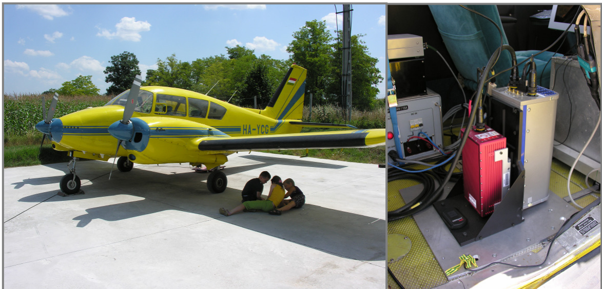
5. ábra: Az alkalmazott Piper Aztec (HA-YCG) típusú repülőgép, és a beépített érzékelő
