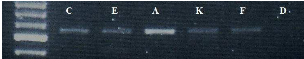
6. ábra: A 2. jelzésű növényi mintákban a HSP70 (kb. 550 bp) gén tesztelése RT-PCR-rel.
