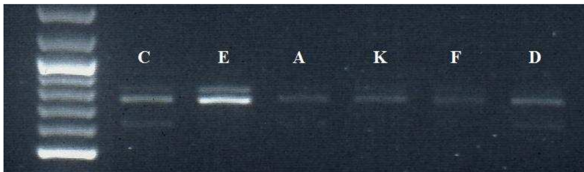
12. ábra: A 7. jelzésű növényi mintákban az oxidatív stresszhez kötődő gén (GST1 primer, kb. 800 bp) tesztelése RT-PCR-ral.
