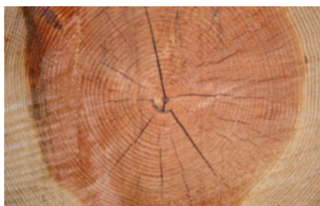
3.ábra. Zsugorodási feszültségek hatására keletkező bélepedések a faanyagon
