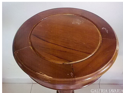
2.ábra. Zsugorodásból származó hibás termék (repedések, hézagok)
