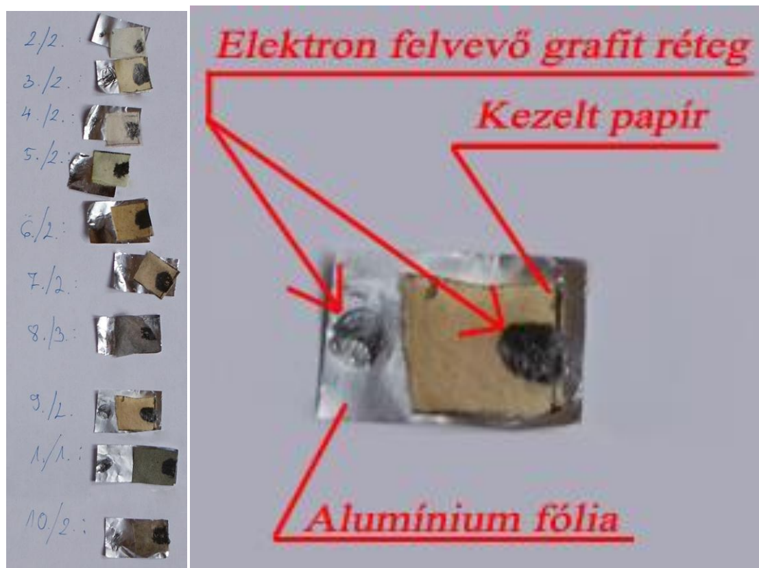
14. ábra: A különböző kezelt papírokból készült próbatestek (balról): 1./1.: szőlő héja, 2./2.: lilakáposzta, 3./2.: főtt cékla, 4./2.: padlizsán, 5./2.: lilahagyma, 6./2.: cékla héja, 7./2.: szilva héja, 8./3.: vörösbör, 9./2.: vörös levél, valamint a próbatestek felépítése (jobbról)
