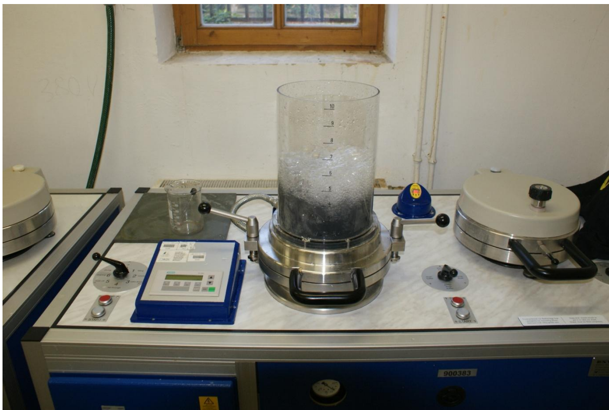
6. ábra: A Papíripari intézet G épületi földszinti laborjában található lapképző gép Ribizli leves papírpép buborékkal történő oszlatása közben
