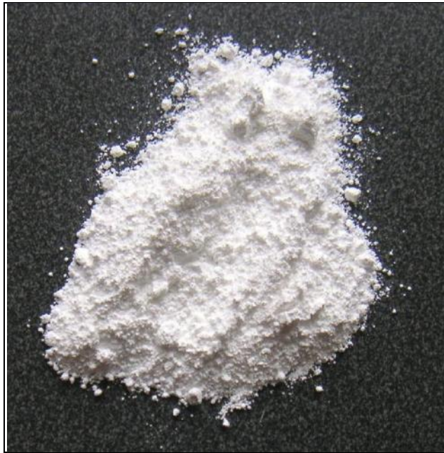
5. ábra: Az előzőleg ultrahangos homogenizátorban elkevert, majd a papírpéphez adott por alakú \text{TiO}_2 , Forrás:
