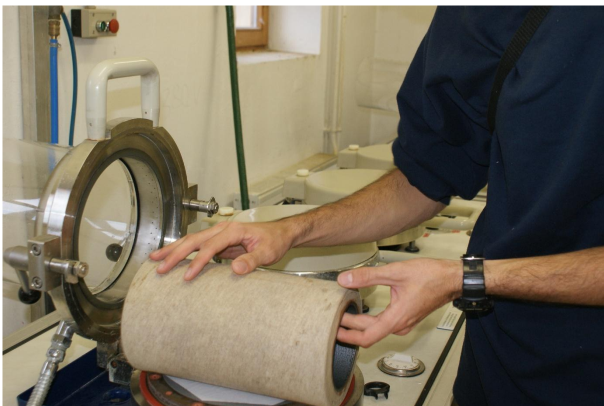
7. ábra: A lapképző szitájára vákuummal leszívott papírlapot, segédpapírra mángoroljuk
