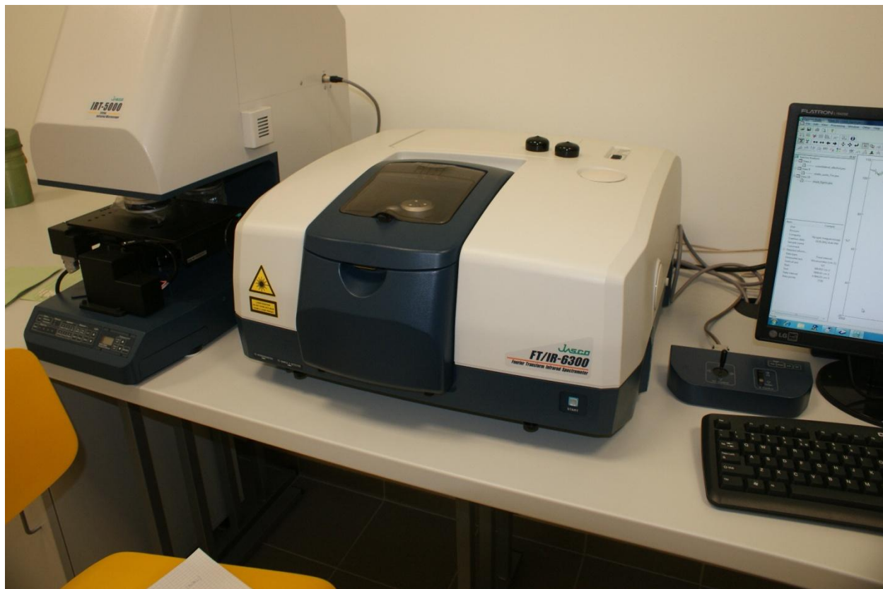
9. ábra: A Jasco FT/IR-6300 Fourier Transform Infrared Spectrometer típusú lézeres spektrófotométerrel
