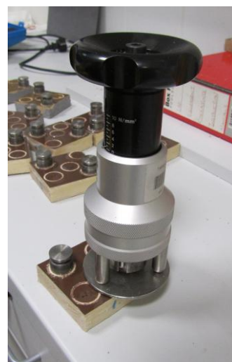
6. ábra: Az Ericsen-féle kézi tapadásvizsgáló műszer →
