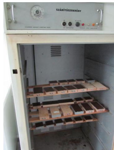
4. ábra: Szárítószekrény mintákkal
