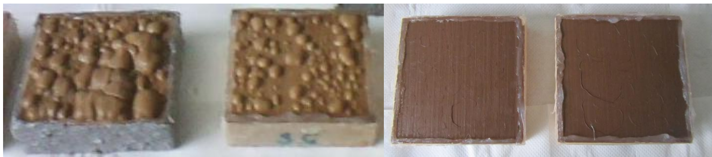
8. ábra: Az előkészítés során felhólyagosodott (balra), és végleges viasszal kezelt próbatestek (jobbra)
