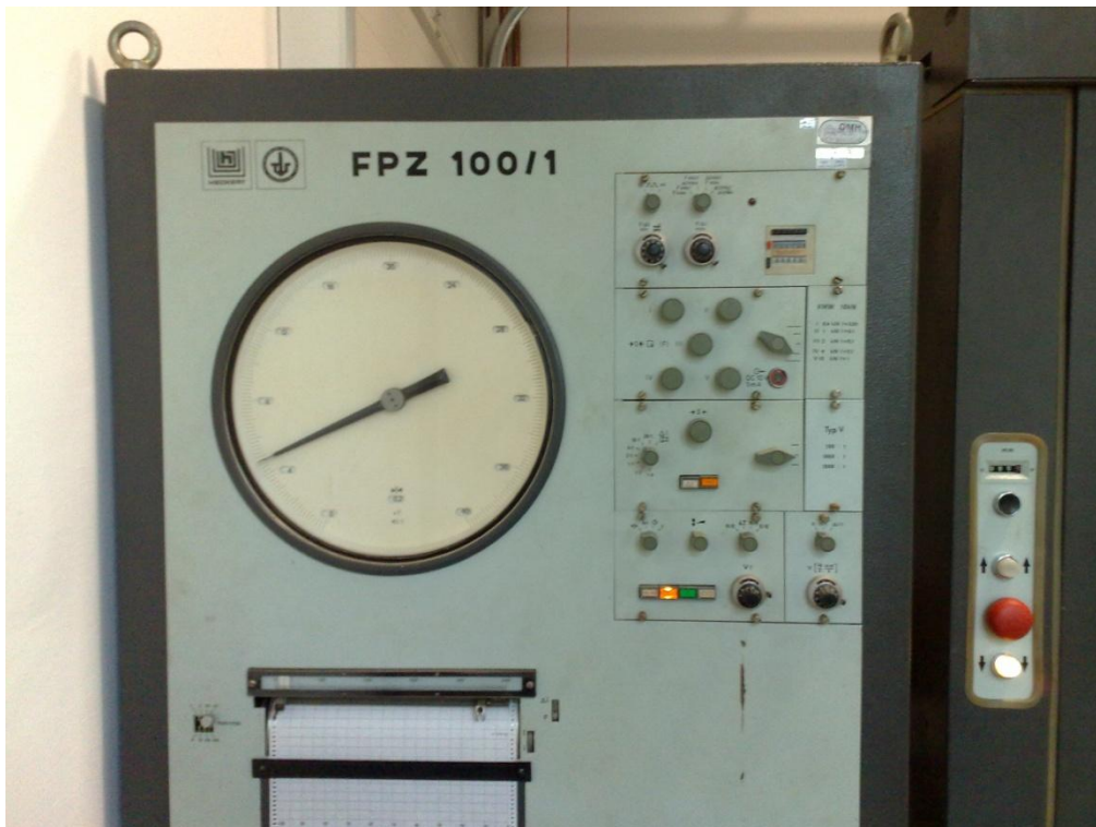
20. kép: a mérőműszer, amiről az erő leolvasható
