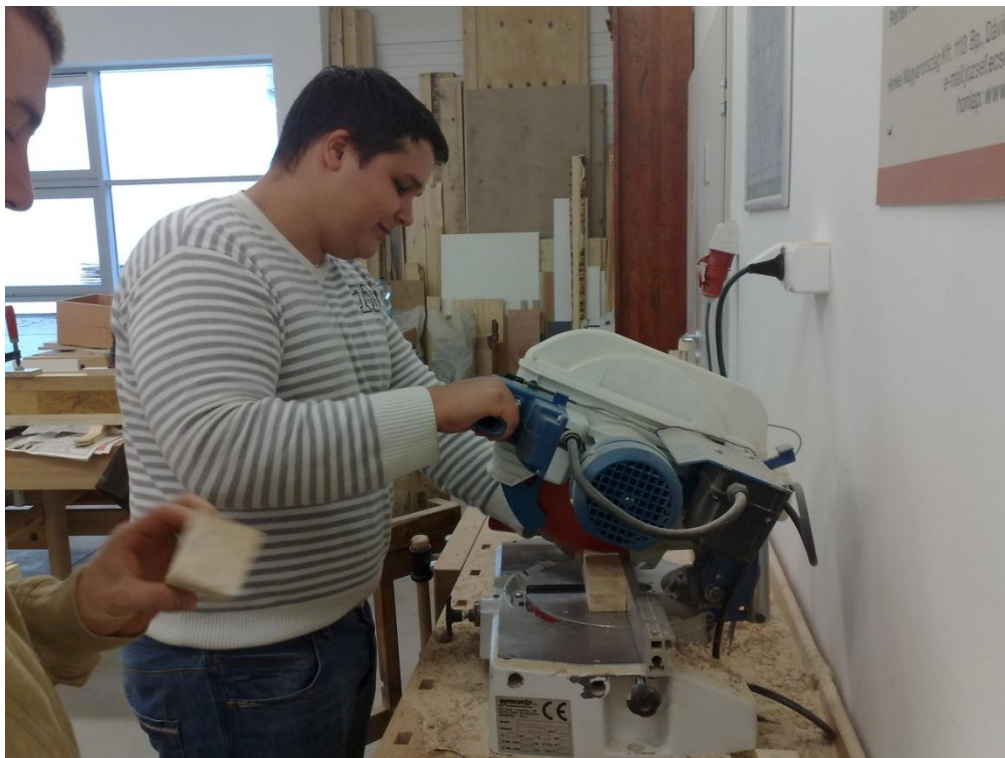
14. kép: a deszkák felszeletelése, téglatestek kialakítása
