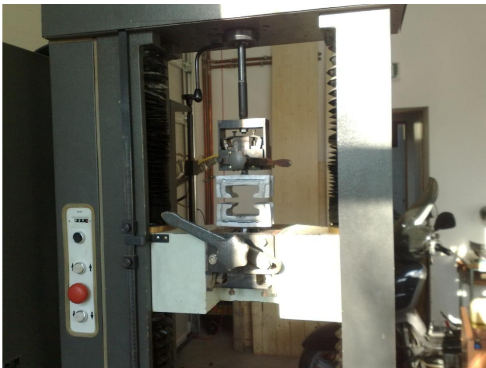
18. kép: FPZ 100/1 általános anyagvizsgáló berendezés a befogó pofákkal
