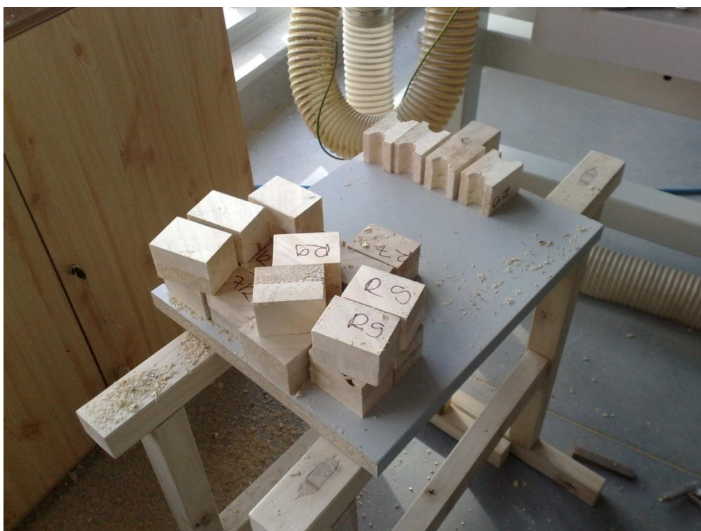
15. kép: bal oldalt a téglatestek, jobb oldalt a már kész próbatestek
