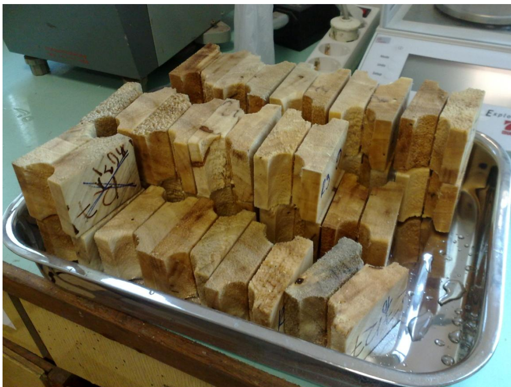
22. kép: Próbatetek áztatás és könnyítés után
