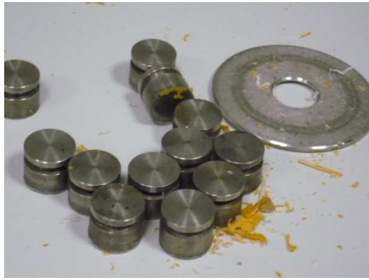
8. ábra – a leszakítás vizsgálatokhoz használt mintahengerek
