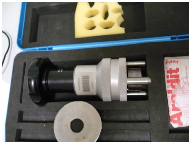
7. ábra: A méréseink során alkalmazott kézi leszakító berendezés
