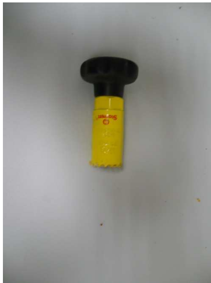
9. ábra: A leszakítás vizsgálatok során használt vágóeszköz
