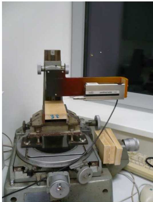
6. ábra: Az érdességmérő készülék
