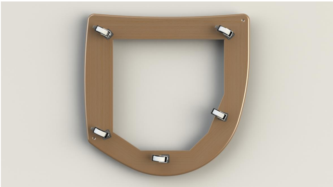
33. ábra - A rögzített kerékgörgők pozíciója felülnézetben
