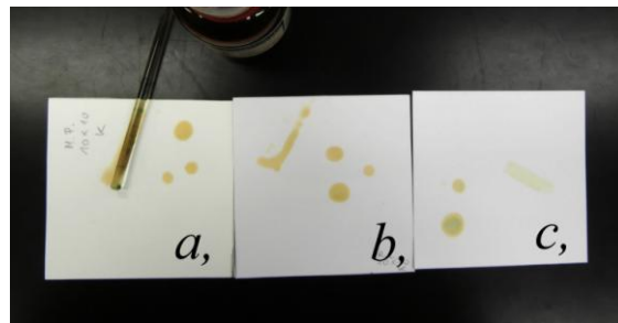
3.13. ábra pH mérés eredményei a, Művészpapír b, Famentes rajzlap c, Canon I.
