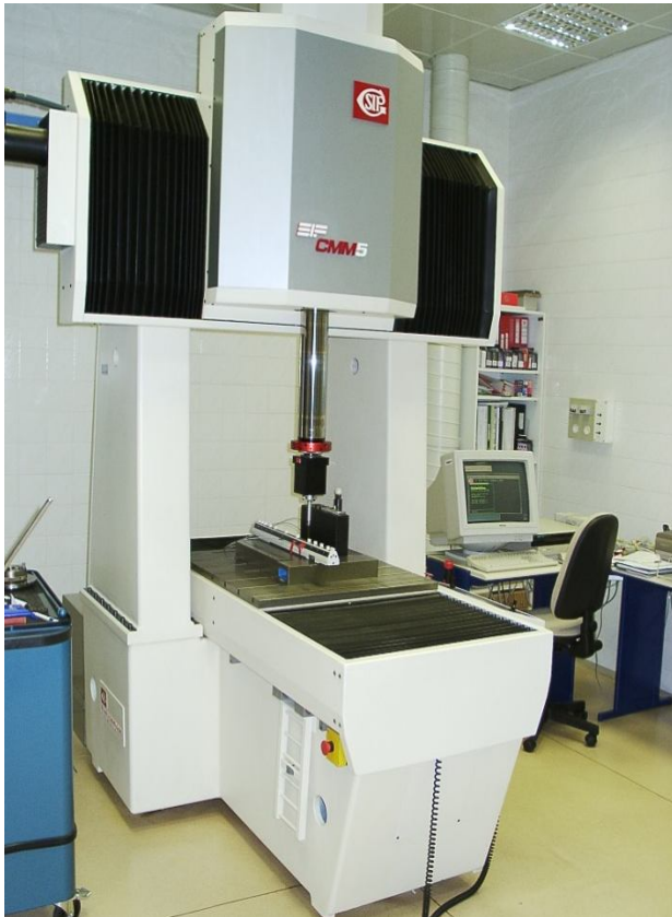
2. ábra A háromdimenziós hosszúságmérés nemzeti etalonja [13.]
