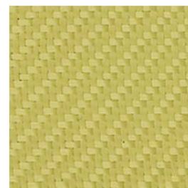
3.4 kép Sávolyszövésű kevlárszövet [12]
