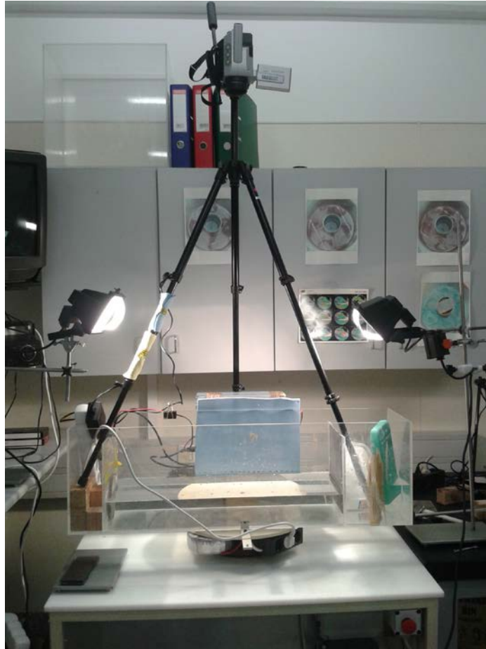
2.2. ábra: Fénykép a kísérleti elrendezésről. A hőkamera együtt forog a medencével, a lámpák azonban rögzítettek.
