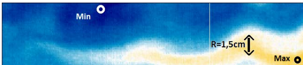
7.5. ábra: A meleg víz jet-szerű áramlása a nyugati partvonalon "észak" felé. t=1230\text{s} , a maximális hőmérséklet 24,9^\circ\text{C} , a minimális 22,7^\circ\text{C} .
