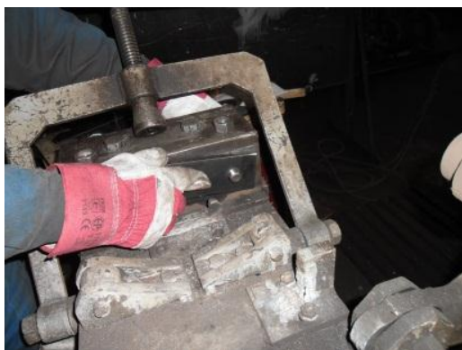
a) A láncszem készülékbe helyezése
