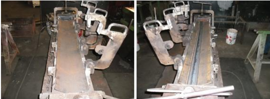
11. ábra Pikkelylemez és az U-acél elhelyezése [15]
