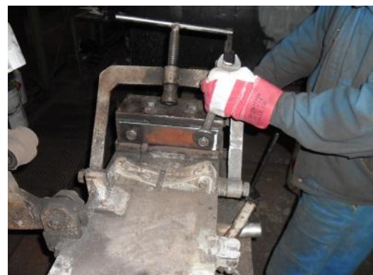
b) A láncszem kézi rögzítése
