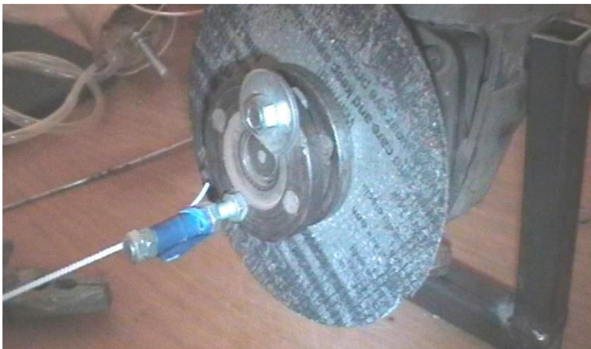
30. ábra Gumiszál gerjesztése sarokcsiszolóval
