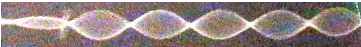
34. ábra A gumiszál toldása és az állóhullámok
