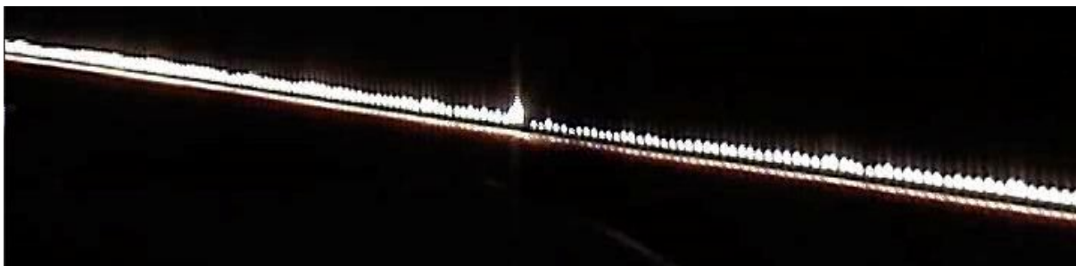
49. ábra Rubens cső begyújtva alaphelyzetben
