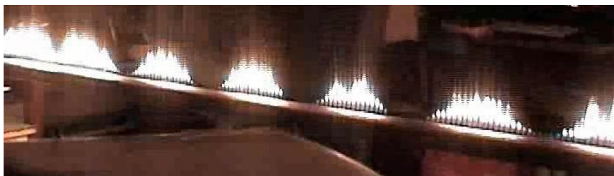
50. Ábra Rubens cső alacsony frekvenciás szinuszhullámmal gerjesztve
