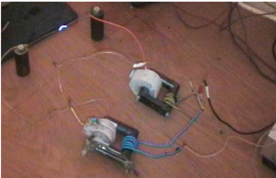
86. ábra Kézzel áttekeresztelt TV sorkimeneti transzformátorok
