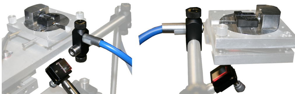
4.5. ábra: Mintatartó állványzat, fotodetektor és Thorlabs tükör.
