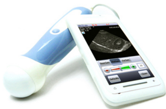
7. ábra. Okostelefon használata fültükrörhöz és ultrahangos képalkotáshoz [27]
