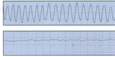
7. ábra. A bal oldali ábrán egy romkutató keresi a romok alatt rekedteket, a jobb oldali ábrán pedig az általa használt radar kimenete látszik. Az ábra felső részén jól látszik, ahol változik a visszavert hullám intenzitása, ez valamilyen mozgásra utal.
