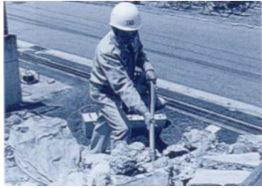
7. ábra. A bal oldali ábrán egy romkutató keresi a romok alatt rekedteket, a jobb oldali ábrán pedig az általa használt radar kimenete látszik. Az ábra felső részén jól látszik, ahol változik a visszavert hullám intenzitása, ez valamilyen mozgásra utal.
