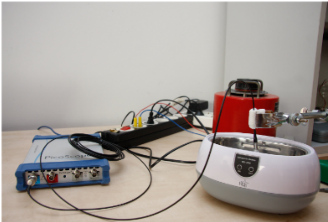
3.2. ábra. Hidrofont mérési elrendezés. A PicoScope által generált jel erősítéssel érkezik a kádhoz. A hidrofón az ultrahangos tisztító kádba merülve monitorozza a kád által kibocsátott jeleket, melyeket egy számítógép dolgoz fel.
