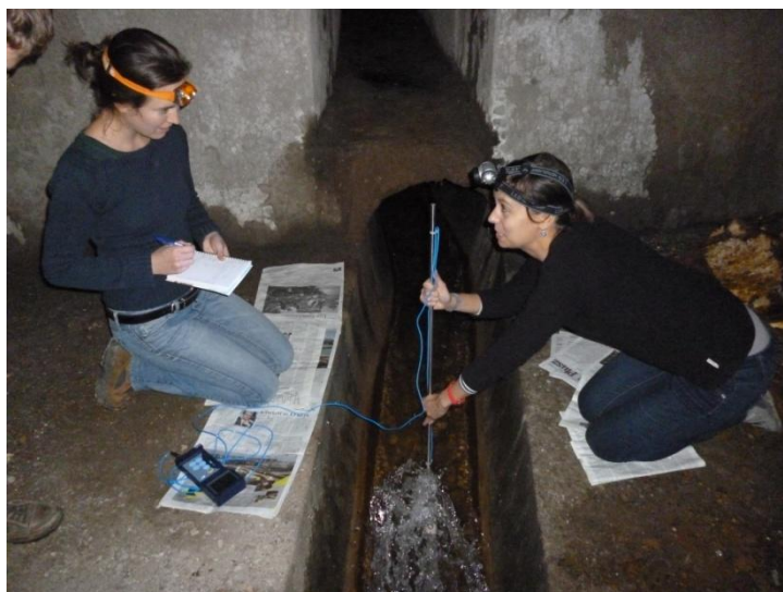
19. ábra: Vízsebesség mérés a csatornában (fotó: Fülöp K.).
