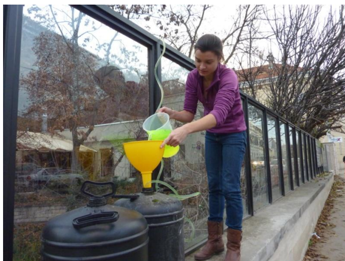
22. ábra: A fluoreszcein folyamatos utánpótlása (fotó: Nyerges A.).
