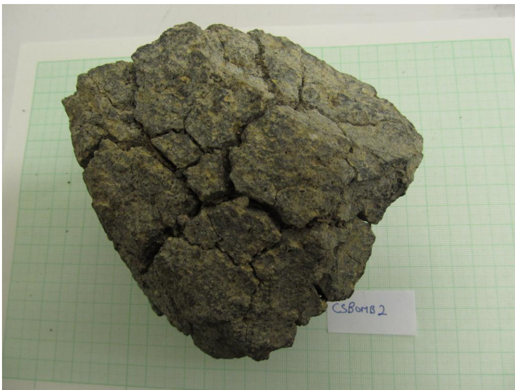
10.ábra A Poligonális repedésrendszer repedései nem köthetők egy kiindulási ponthoz, egymás irányait elmetszve sokszöges szerkezeteket hoznak létre.
