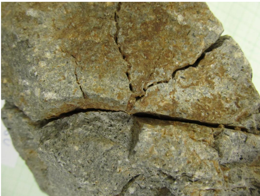
9.ábra Az Ágas repedésrendszert alkotó repedések egy pontból indulnak különböző irányokba, egymást nem metszik és önmagukba vissza nem térnek.
