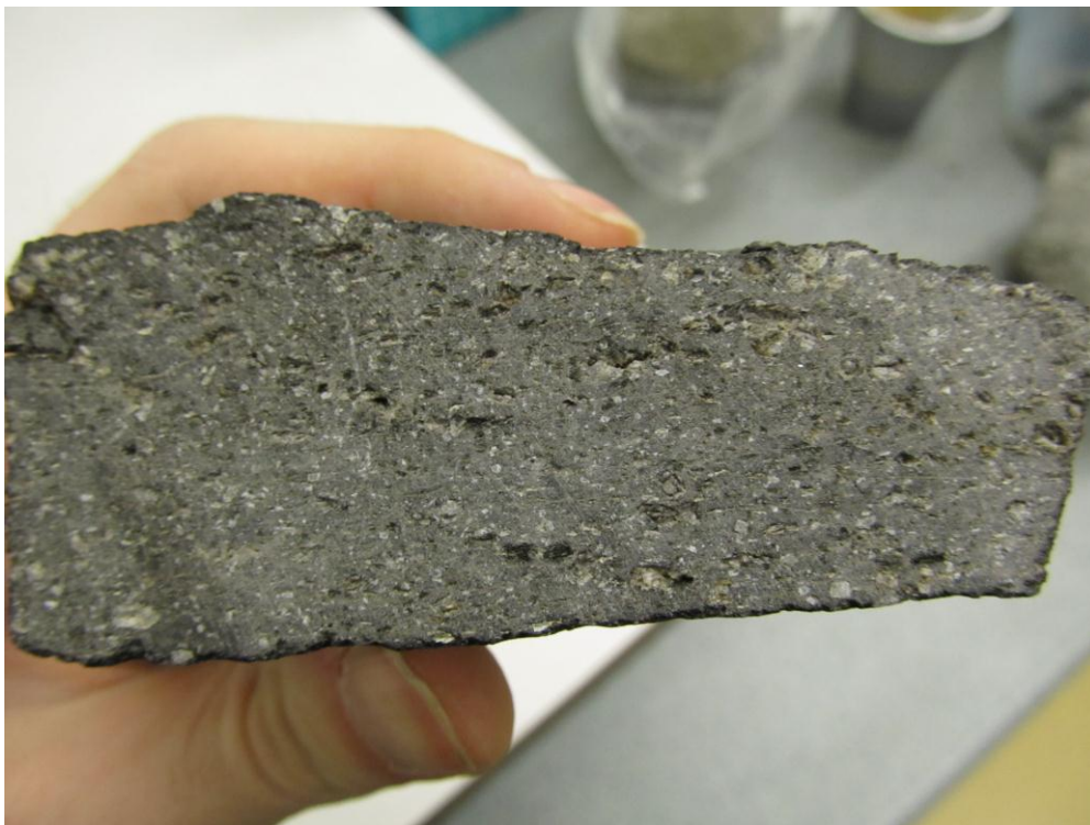
15.ábra A sűrű blokkok szövete egységesnek tekinthető , nem osztható fel különálló részekre és minden esetben sötét megjelenést mutat.
