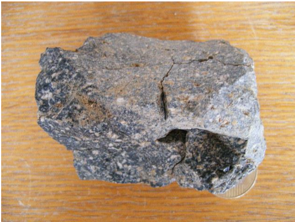
24.ábra Ágas repedésrendszerben lévő repedés által eltört fenokristály
