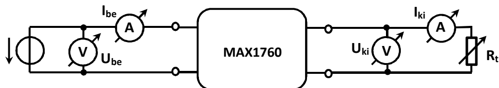
32. ábra A MAX1760 hatásfokának mérése
