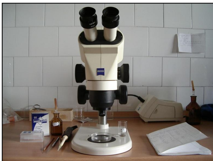
4. ábra: A ragadozó atkák preparálásához használt sztereomikroszkóp és egyéb szükséges eszközök (Fotó: Dr. Szabó Árpád)
