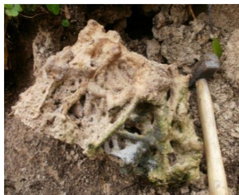
1. ábra: A mésztufa porózus szerkezete.
