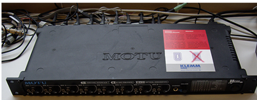
2. ábra. Az A/D-konverterként használt mikrofons erősítő
