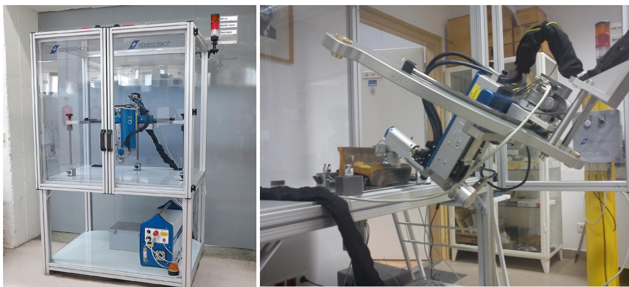
16. ábra Stresstech G3R röntgendiffraktométer sugárvédelmi fülkében és állványon
