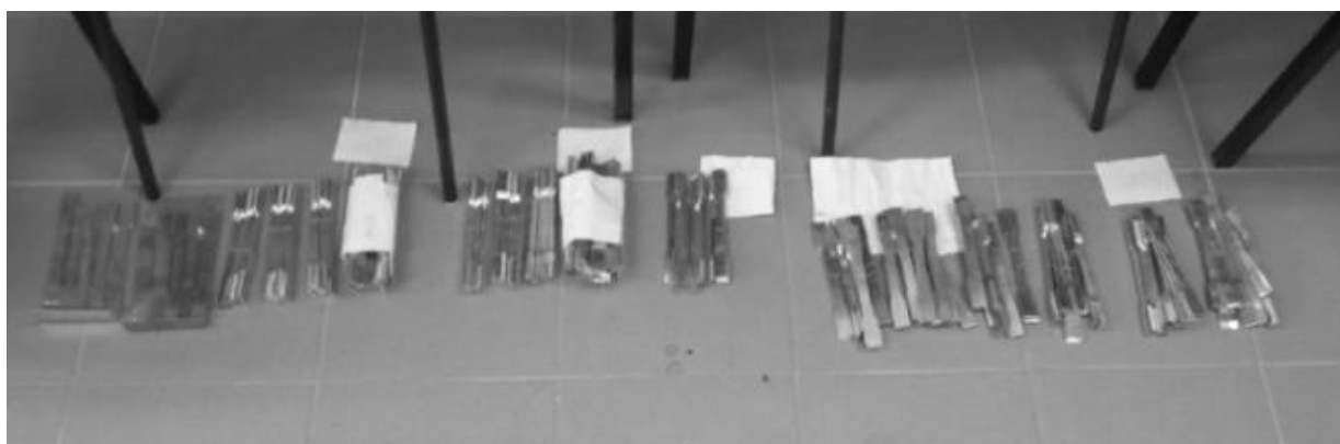
3.2.1 sz. ábrán Egy órás izotermásan hőkezelt szabványosan kimunkált szakítóminták.
