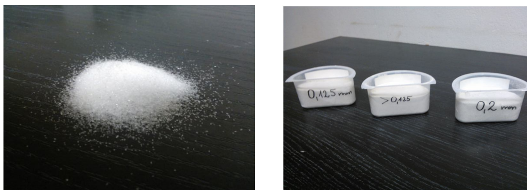
8. ábra Aprított majd különböző frakciókra szétválasztott üveg hulladék
