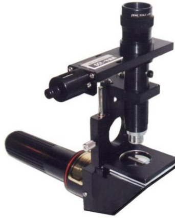
15. ábra. Az élfeszültségmérő készülék
