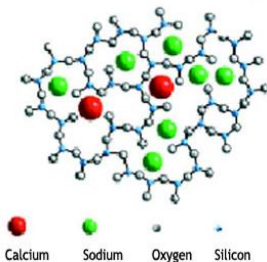
2. ábra. Nátrium beépülése az üveg szerkezetébe http://www.pilkington.com/pilkington-information/about+pilkington/education/chemistry+of+glass.htm
