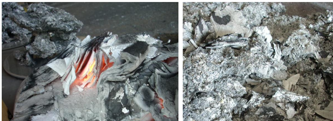
7. ábra A nagy fajlagos felületű vékonyfalú anyagok oxidációjának eredménye (a – még izzó állapotban kivett leveles darab, b – lehűlt salakban elszórt leveles oxidált darabok)
