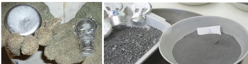
11. ábra Egy nagy fémtartalmú salakmintából kiolvasztás és mechanikus feltárás-szeparálás után kapott tömb, durva és finom anyagok, köztük az érempróba képe
