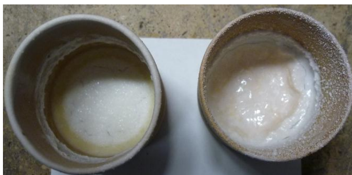
28. ábra A kezelősó és a tisztítósó olvasztása után kapott megszilárdult minták képe.
