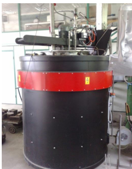
5. ábra SLR – 5 típusú karbonitridáló kemence
