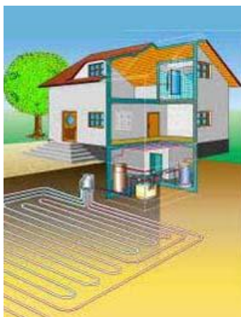
5. ábra: Talaj kollektoros rendszer elve [6]
