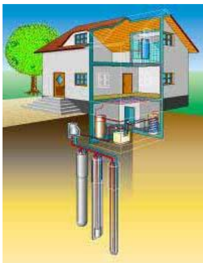
6. ábra: Talajszondás rendszerek [6]
