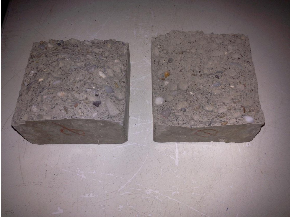
27. ábra: A 0-jelű keverékből készült próbakocka hasításképe
