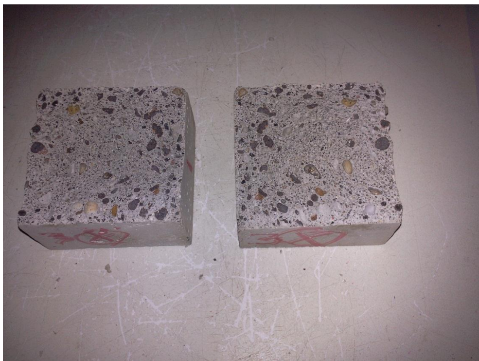
26. ábra: A 3X-jelű keverékből készült próbakocka hasításképe
