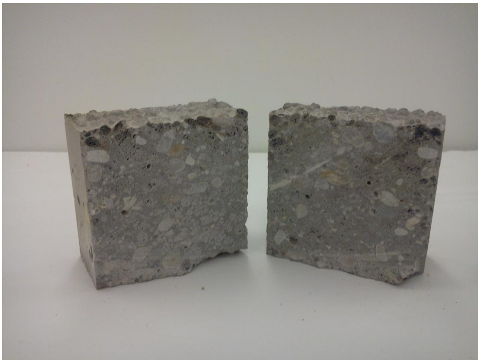
30. ábra: Az A-jelű keverékből készült próbakocka vágásfelülete
