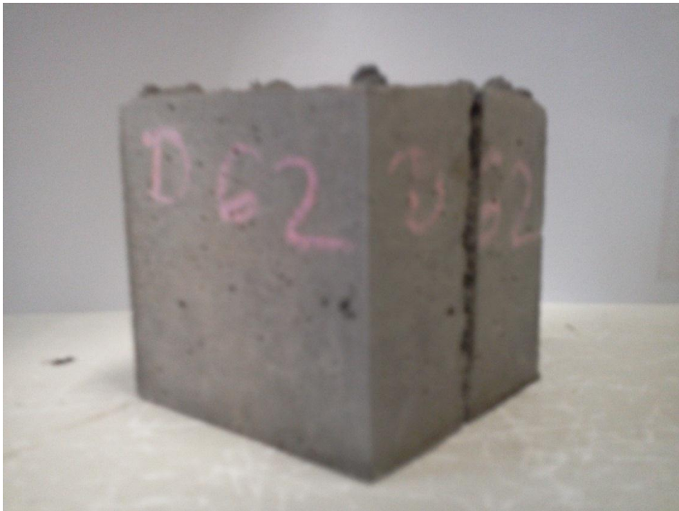
43. ábra: A D62-jelű keverékből készült próbakocka
