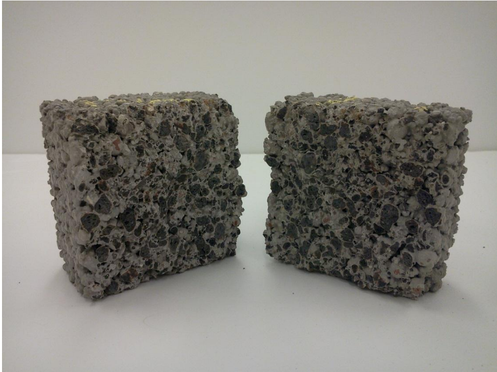
35. ábra: Az E-jelű keverékből készült próbakocka hasításképe
