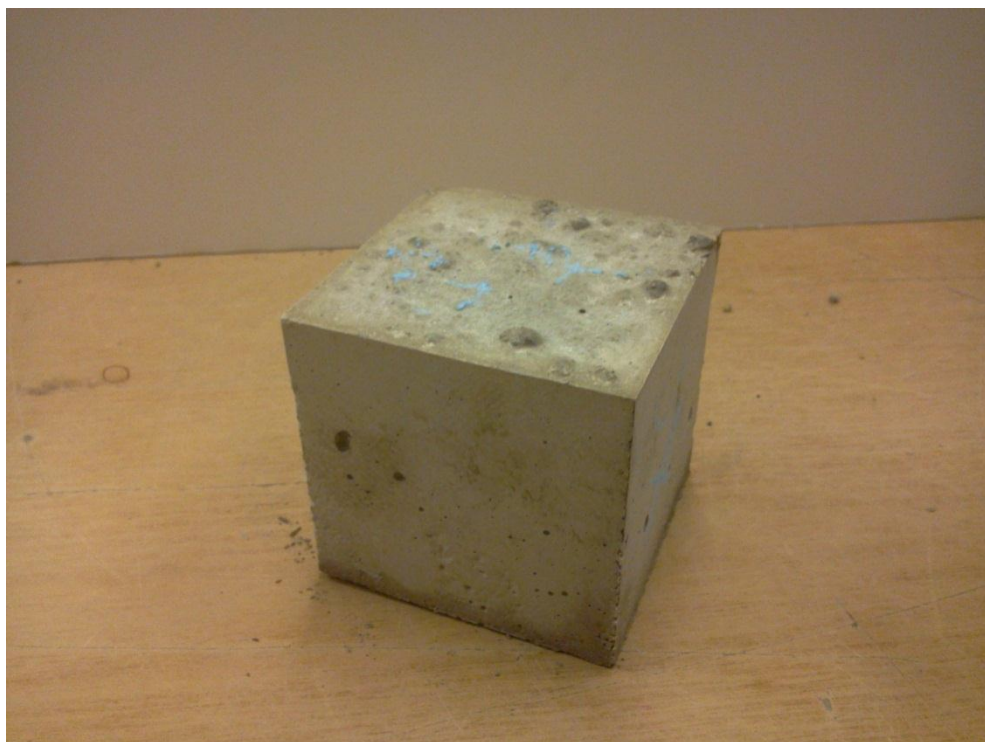
25. ábra: A 3X-jelű keverékből készült próbakocka
