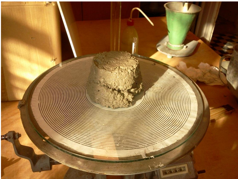
21. ábra: Az X-jelű keverék terülése
