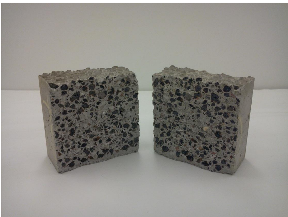
33. ábra: A D-jelű keverékből készült próbakocka hasításképe
