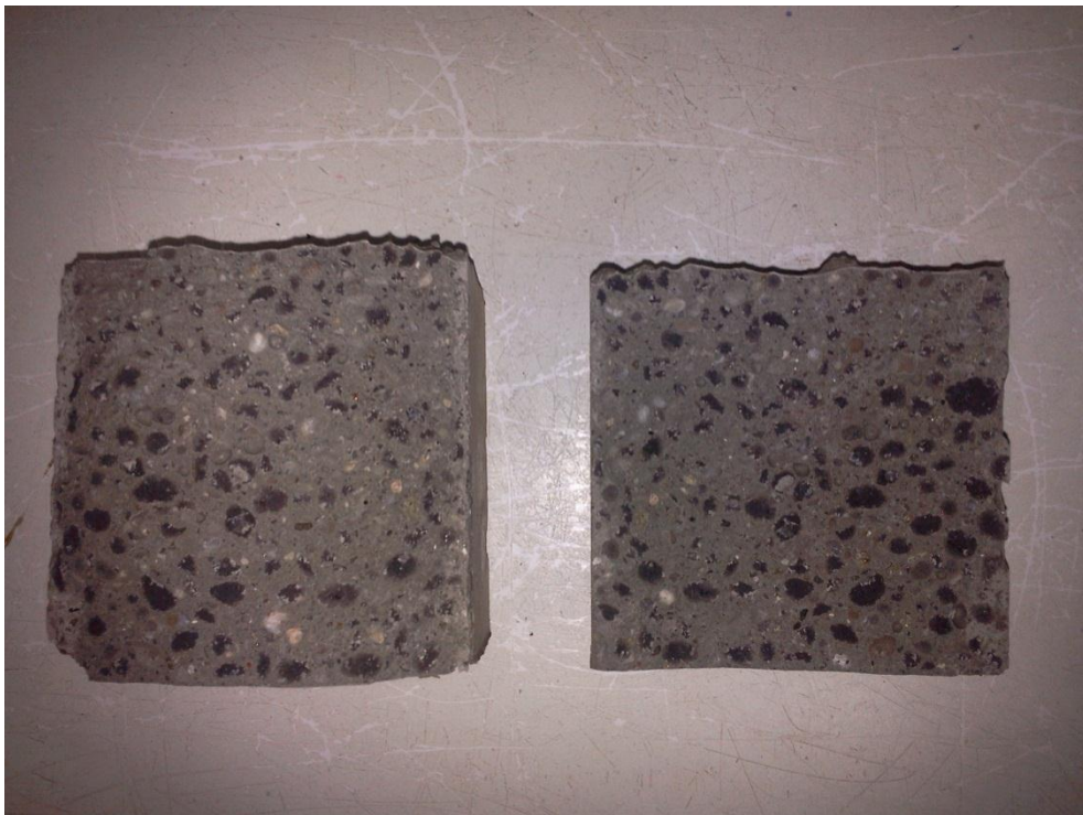
40. ábra: A D61-jelű keverékből készült próbakocka hasításképe
