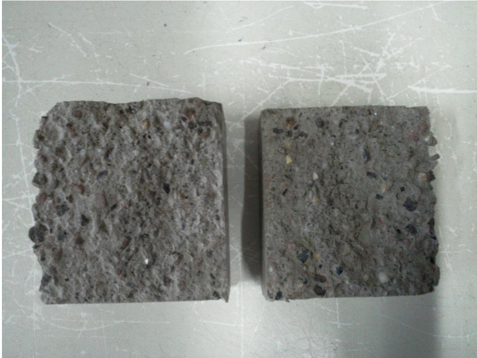
29. ábra: Az A-jelű keverékből készült próbakocka hassításképe
