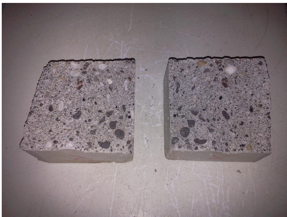
23. ábra: Az X-jelű keverékből készült próbakocka hasításképe
