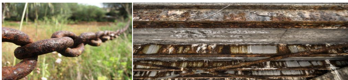
5-7. ábra: Példák a fém korrózióra [7.]
