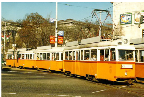
37. ábra UV típusú villamos Budapesten. Két motorkocsi közé egy pótkocsi is csatolható
