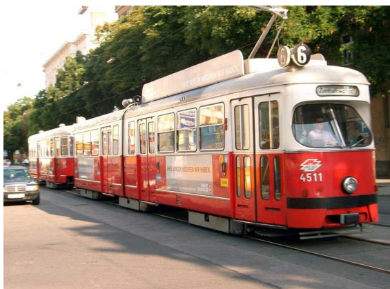
39. ábra Hattengelyes, Jacobs-forgóvázaz csuklós villamos Bécsben
