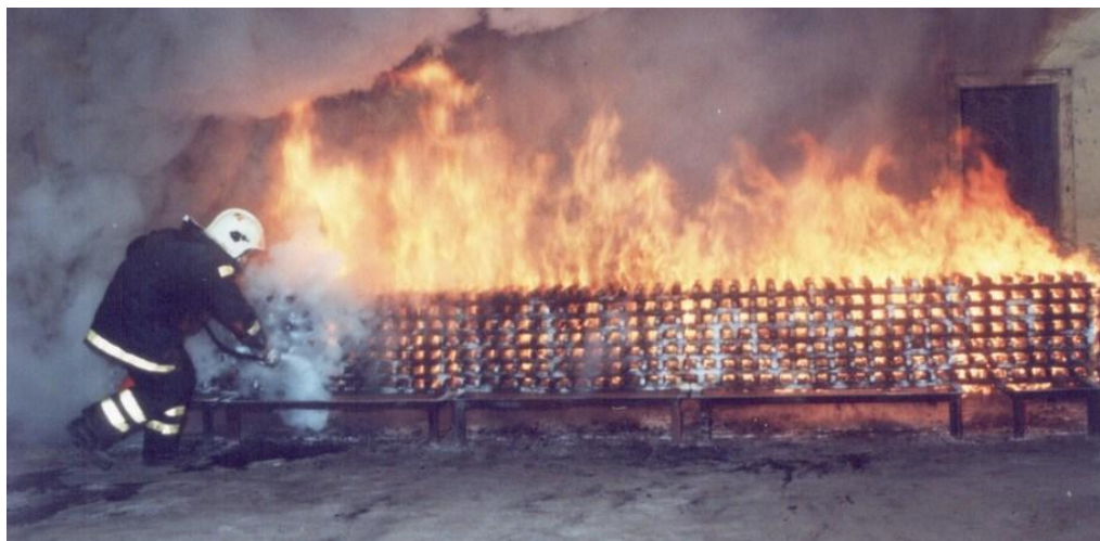
2. ábra – 55A jelű vizsgálati tűz oltása
