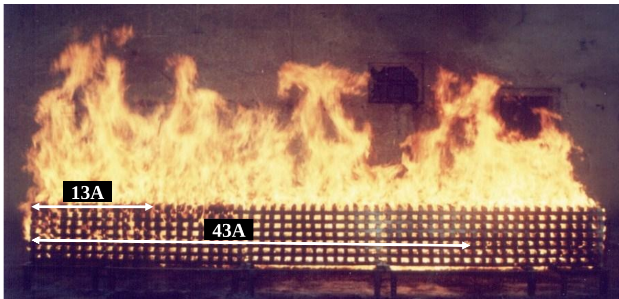
4. ábra – 13A és 43A egységek viszonyának szemléltetése egy 55A jelű vizsgálati tűzön
