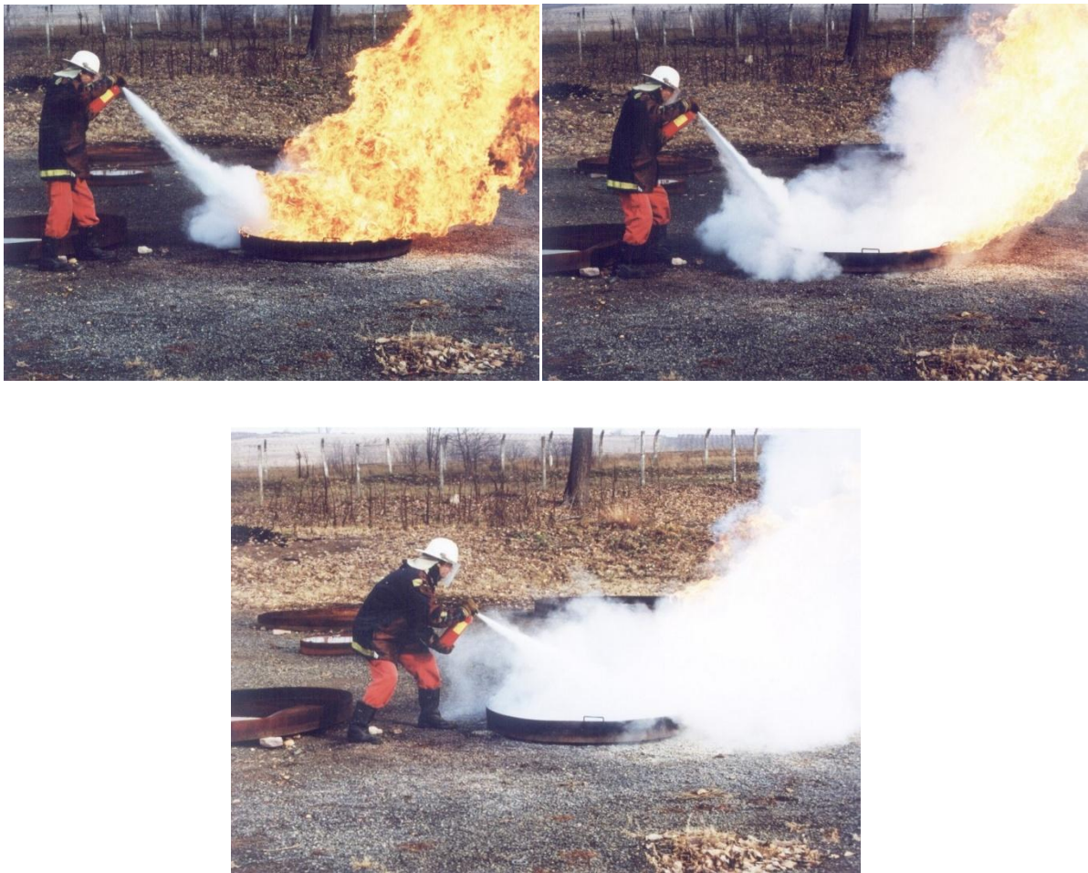
3. ábra – B jelű vizsgálati tűz oltása porral oltóval
