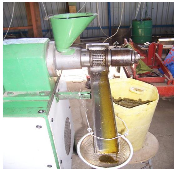
8-9.ábra: a repceolaj préselése
