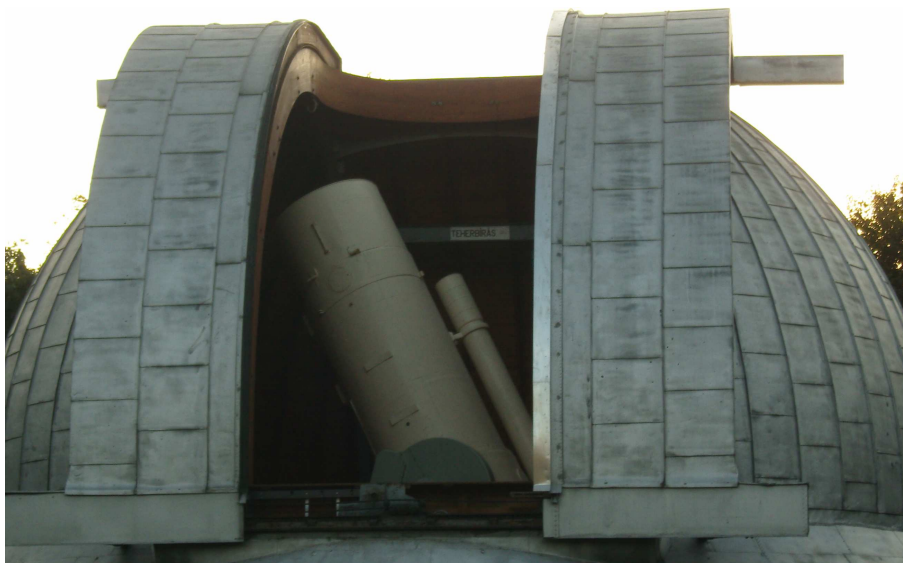
7. ábra: A Schmidt rendszerű 60/90/180 cm-es távcső Piskés-tetőn, mellyel az optikai mérések készültek.
