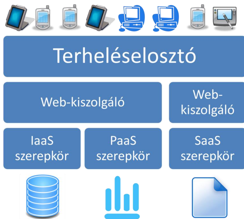
12. ábra - az Azure szolgáltatások struktúrája, forrás: Farkas et al (2013)
